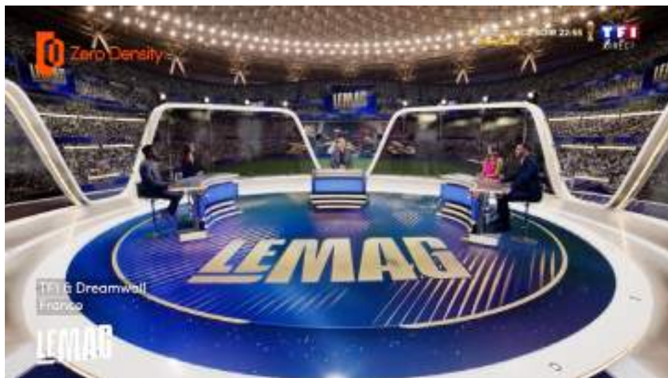
Vrai plateau, qui intègre un sol LED, un mur de LED incurvé derrière les journalistes, et un fond vert au-dessus du mur LED, afin de prolonger à l'écran ce qu'il affiche.
